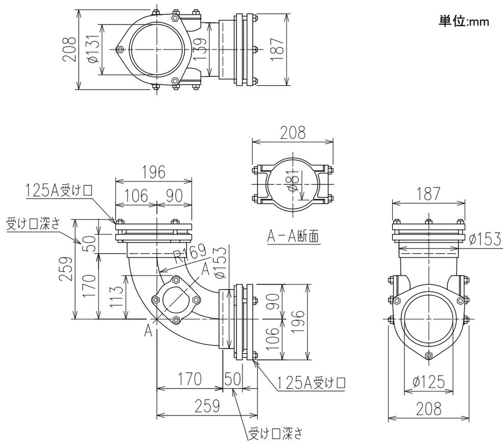
注) 本製品は最下階専用集合管 (4SRシリーズ) 専用です。5HF形集合管など、立て管径125Aの排水立て管システムに使用しないでください。
