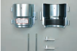
延焼防止金物、六角ボルト、支持金具付高ナットを用意します。延焼防止金物は、消防評定シールありなしの2個を1組としてご使用ください。
