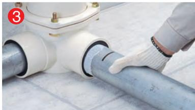
3 差し口のマーキング位置まで、管を挿入します。挿入時には受け口部のゴム輪を一緒に押し込まないように注意してください。
