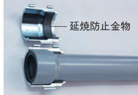
延焼防止金物を、直管の受け口にかぶせまします。金物は、消防評定シールありなしの2個を1組としてセットしてください。
