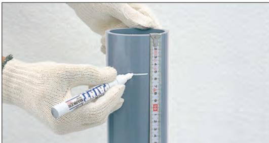
●挿入パイプ外面に挿入深さをマーキングします。
