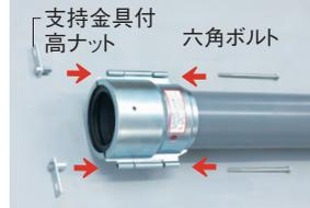
金物両側のヒンジ部に六角ボルトを通し、支持金具付高ナットを取り付けます。
