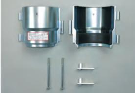
延焼防止金物、六角ボルト、支持金具付高ナットを用意します。延焼防止金物は、消防評定シールありなしの2個を1組としてご使用ください。
