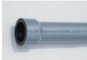
所定の長さの直管を用意します。管は直角に切断し、切断後の管端部は面取りを施して、バリ・カエリ等を除去してください。
