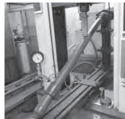
Eロック接合部・限界曲げ試験の様子 試験機の限界まで曲げても漏水・異常なし
